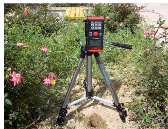
عکس (۲): استقرار متر لیزری بر روی چاهک
