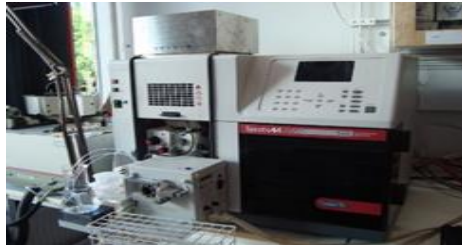
شکل ۲. دستگاه جذب اتمی (Varian, SpectrAA, 55B)
