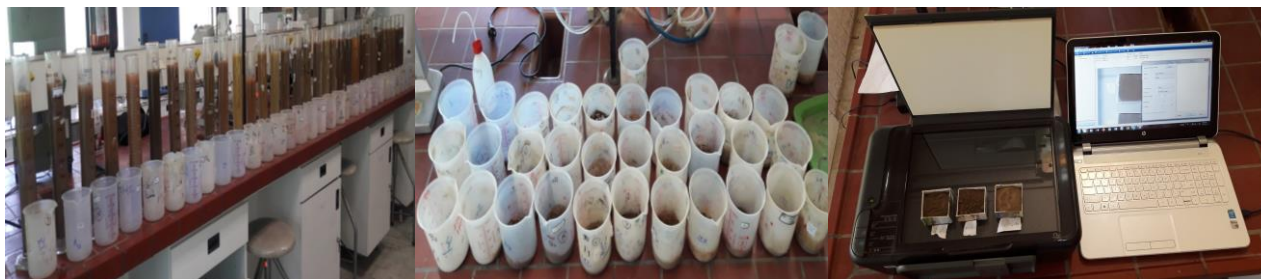
شکل ۱. نمای کلی از مراحل تعیین بافت و تصویربرداری با اسکنر از نمونه‌های خاک
