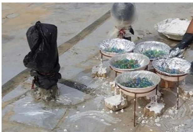
شکل ۲. تله رسوبگیر استفاده شده جهت نمونه برداری ذرات گردوغبار
