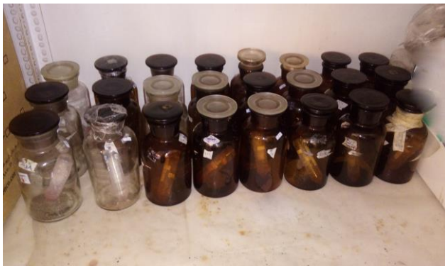
شکل ۲- (جار شیشه‌ای برای اندازه‌گیری تنفس پایه میکروبی خاک)
