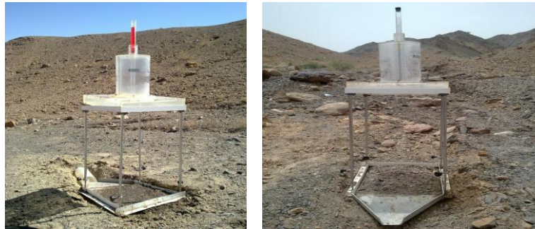
شکل ۲ دستگاه در حال شبیه سازی باران در منطقه
