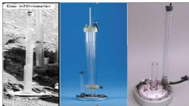
شکل 1. دستگاه نفوذسنج مکشی استفاده شده (Soilmoisture Equipment Crop. P.O. Box 30025, Santa Barbara, CA 93105 U.S.A.) برای اندازه گیری نفوذ آب به خاک از نماهای مختلف.
