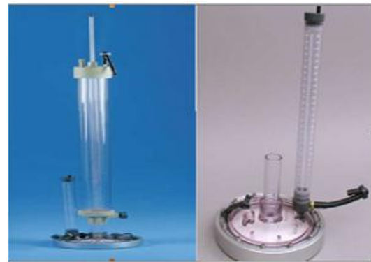
شکل 1. دستگاه نفوذسنج مکشی استفاده شده برای اندازه گیری نفوذ آب شکل 2. محل های آزمایشی (69 نقطه) در طرح تودرتوی به خاک. استفاده شده برای نفوذ آب به خاک در منطقه مورد مطالعه.
