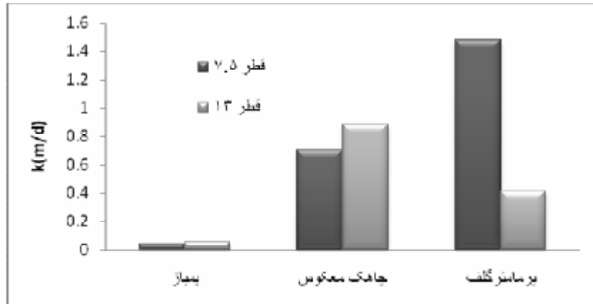
شکل ۱ - نمودار تغییرات هدایت هیدرولیکی در قطر و روش‌های مورد نظر
