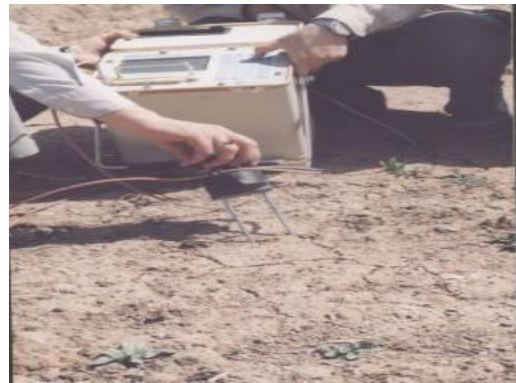
شکل 1- اندازه گیری رطوبت با TDR
