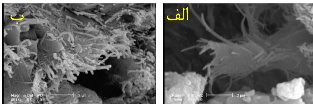
تصویر ۱- میکروگراف الکترونی روبشی (SEM) نشان دهنده وجود مقدار فراوان پالیگورسکایت مارن گچی میوسن (الف) و عمق ۸ متری مقطع لسی (ب)
