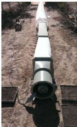
شکل ۳: نمونه شماتیک و تصویر دستگاه سنجش فرسایش بادی مورد استفاده
