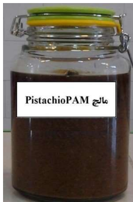
شکل ۱: نمونه مالچ PistachioPAM که از ترکیب ۲۰۰ گرم بقایای حاصل از برداشت پسته (>۲ میلی‌متر) با محلول پلی‌آکریل‌آمید - آب حاصل شده است.
