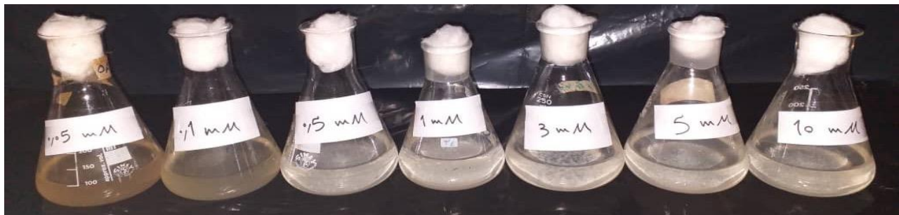
شکل ۳- کاهش رشد باکتری در محیط کشت با غلظت‌های مختلف سرب پس از ۴۸ ساعت انکوباسیون
