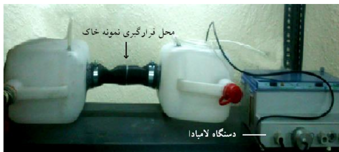
شکل ۲. نمایی از دستگاه دست‌ساز اندازه‌گیری ضریب پخشیدگی گاز CO_2 در خاک
