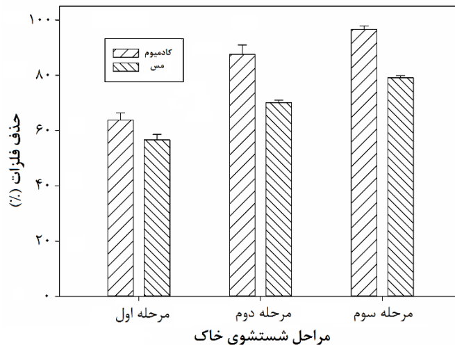
شکل ۳- شستشوی سه مرحله‌ای خاک آلوده (زمان آزمایش برابر ۷۲۰ دقیقه و غلظت هیومیک اسید برابر ۳۰۰۰ میلی‌گرم کربن بر لیتر)
