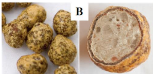
شکل ۵- سینتیک رهایش فسفر از کودهای کندرهای تولید شده (راست) و کود اولیه دانه‌های کود NPK کندرهای تولید شده و برش عرضی آن (چپ) (Lubkowski, 2014).
