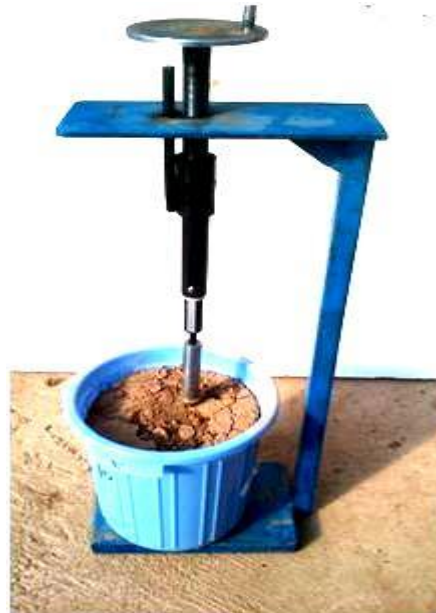
شکل ۳-۲ نمایی از فروسنج مخروطی برای اندازه‌گیری مقاومت مکانیکی خاک درون گلدان
