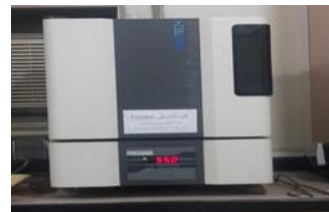
شکل ۱- کوره الکتریکی برای تهیه زغال زیستی
