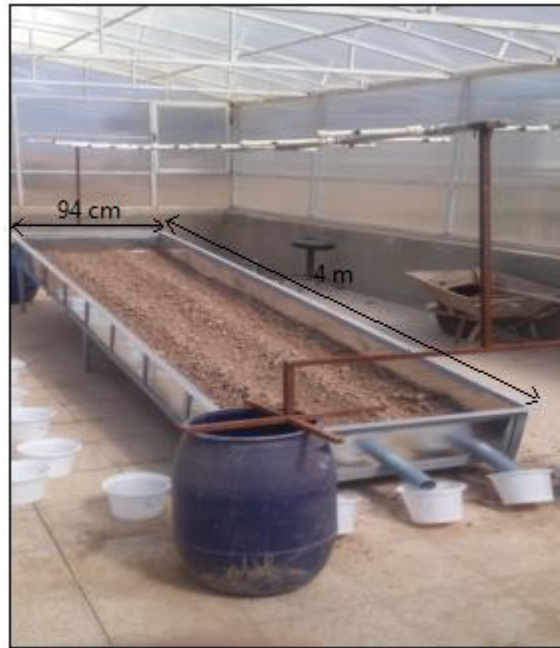
شکل ۱- نمایی از فلوم فرسایشی و دستگاه شبیه‌ساز باران مورد استفاده در پژوهش
