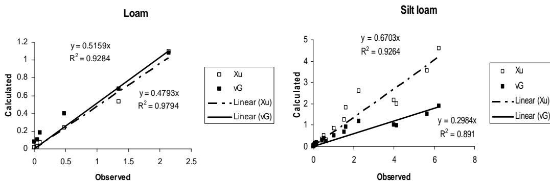
شکل ۱- مقادیر پیش بینی شده هدایت هیدرولیکی غیراشباع توسط دو مدل زو و ون گنوختن نسبت به مقادیر اندازه گیری شده برای دو بافت لوم و لوم سیلتی
