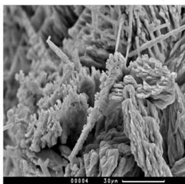
شکل ۲- آهک های سوزنی شکل با لبه های صاف و دنداندار
